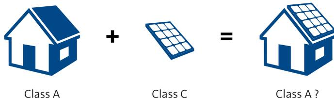
现在绝大多数情况，组件等级和建筑等级要求不一样，故如何评估和设计光伏组件和系统，来避免光伏系统自身的起火就尤为重要。自 2008 年起，由美国能源部的资助，UL (Underwriters Laboratory) 和 Solar ABCs (The Solar America Board for Codes and Standards) 建立了一套试验计划来研究和解决与分布式光伏系统有关的一系列防火问题。通过长达 5 年的研究，得到了大量的实验数据和研究成果，在这些研究成果的基础上，最终发布了 UL 1703 的最新修订。
