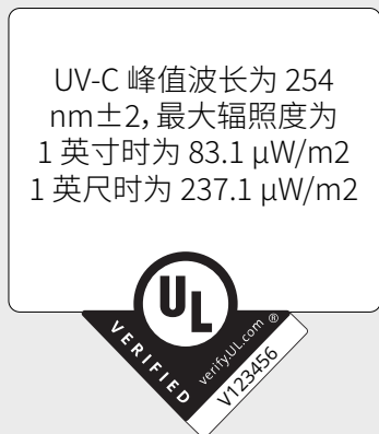
图 2: 经批准的 UL 认证标志测量辐照度的示例
