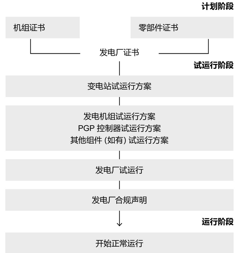
图 6: 发电系统流程图
